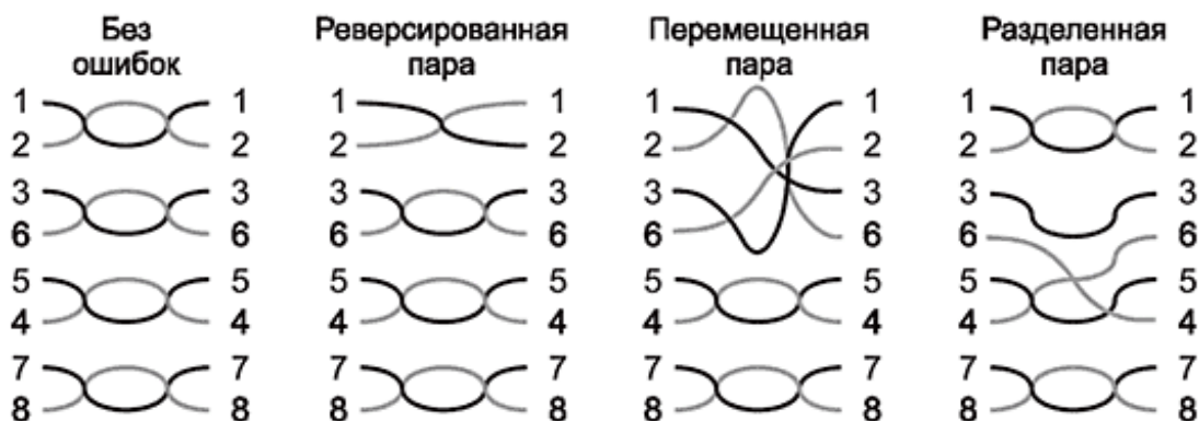
Рисунок 3 - Возможные ошибки в схеме разводки
