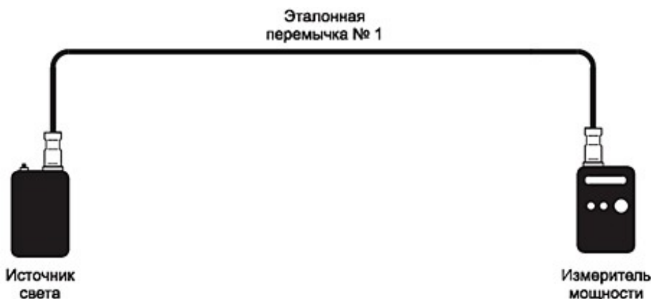
Рисунок 6 - Калибровка 1 - измерение уровня мощности, инжектируемой в волокно источником света
